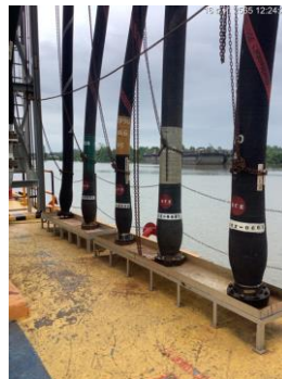
ภาพที่ 2-8 ถาดรองน้ำมันที่อาจรั่วหกและวาล์วที่ปิดดักน้ำมันปิดตลอดเวลาการขนถ่ายน้ำมันที่ทำ
