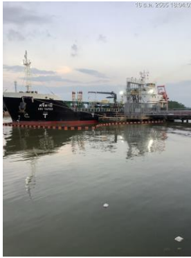
ภาพที่ 2-6 การล้อมทวน (Boom) รอบลำเรือบรรทุกน้ำมัน
